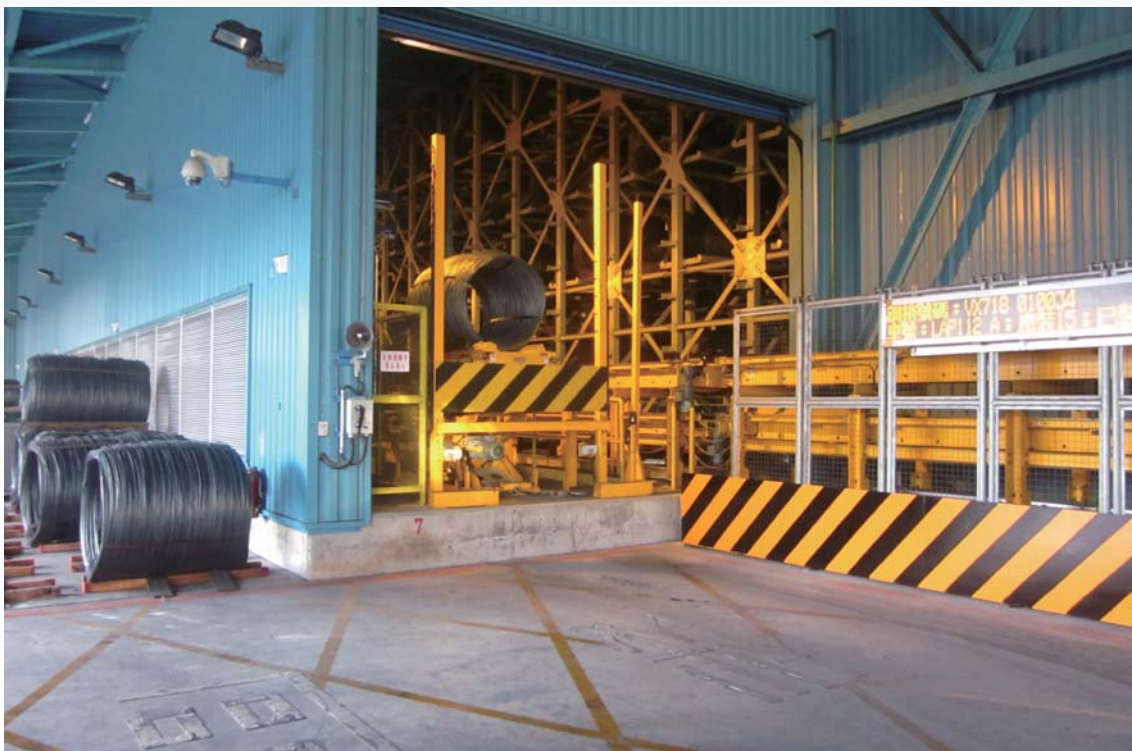
盤元軋製完成可全自動化進庫儲放，可確保盤元外觀品質。
