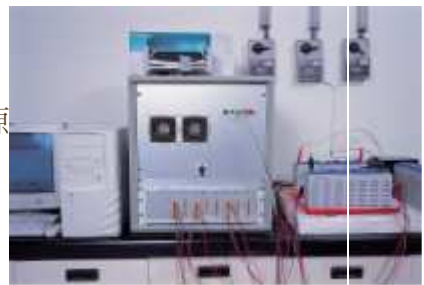
▲電磁機車電池充放電儀器
