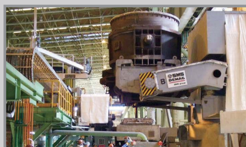
鋼液澆鑄作業
