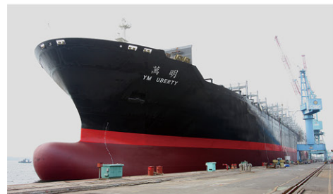
使用高強度船用鋼板 EH40 所建造之超大型貨櫃船：陽明海運 8200TEU 超大型「萬明」號。
