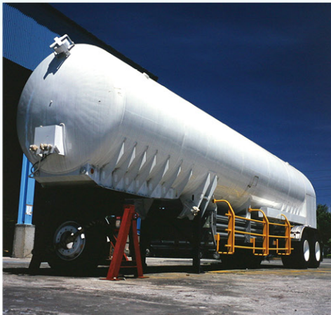
使用壓力容器用鋼製造的貯槽車
