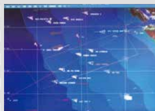
電腦顯控系统顯示各船舶動態情形（船名、航向）
