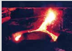
熾紅的鐵水從熔融還原反應爐汩汩流出
