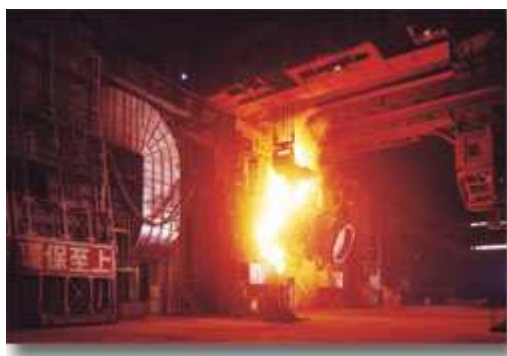
六號轉爐鐵水加料作業
