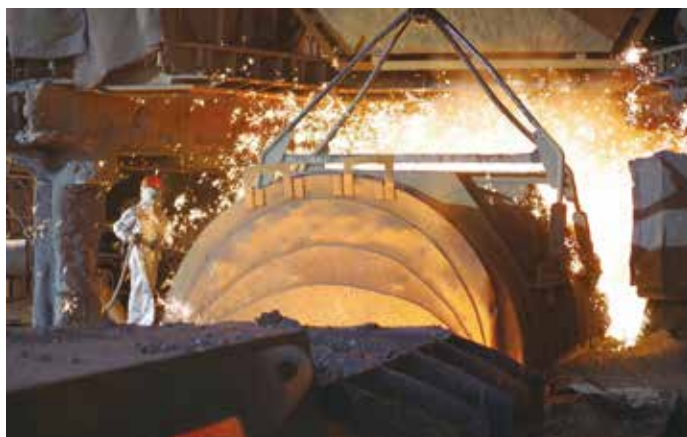
高爐出鐵作業情形
