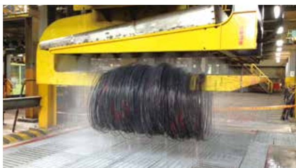
澆淋特製潤滑劑，降低線圈間磨擦係數
