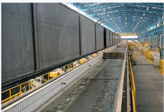
第三酸洗冷軋線噴射式酸洗槽
