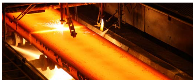
扁鋼胚焰切作業
