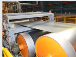
第 3 水平式退火塗覆線熱試車作業
