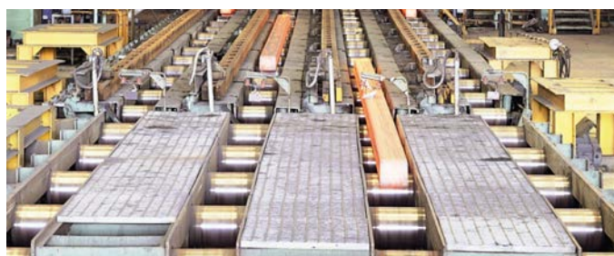
大鋼胚長度偵測作業
