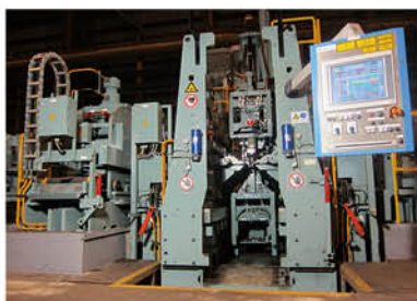
第二酸洗冷軋線 (PLCM) 銲接機
