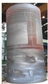
使用 Alloy 800H 熱軋捲製成之加熱 爐內罩
