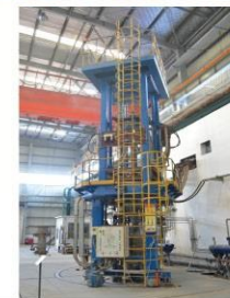
惰性氣體保護電渣 重熔爐 (鎳基合金)
