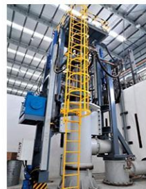
3 噸真空自耗電弧爐
