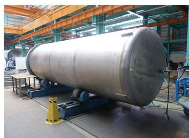
純鈦中厚板製造的工業用化工桶槽
