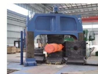
將真空電弧重熔圓型鑄錠打成扁胚、大方胚，作為後續軋延成厚板、盤元及熱軋捲。
