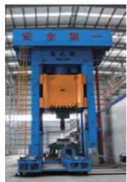
將海綿鈦壓製成鈦電極塊，作為真空電弧熔煉的電極錠。
