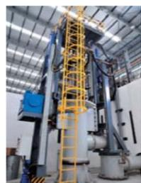
將多個鈦電極塊銲接成鈦電極錠，在真空或惰性氣體保護下經 2~3 次熔煉成鈦鑄錠。
