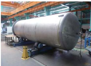
純鈦中厚板製造的工業用化工桶槽
