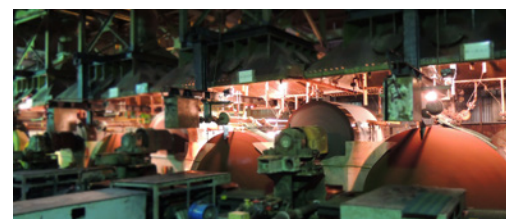
電鍍鋅區 CAROSEL 型式電鍍槽
