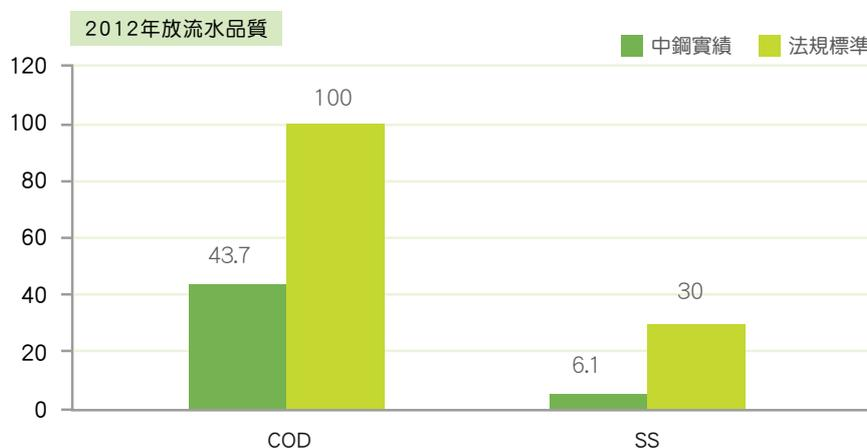
中鋼除利用廢水處理廠處理製程廢水外，亦針對煤、鐵等原料區之逕流廢水設置4萬噸的逕流廢水收集池及處理場(處理容量3.6萬噸/日)，將大雨產生的逕流廢水處理到放流水標準後再經60米大排排放至大海，有效降低逕流廢水污染量。
