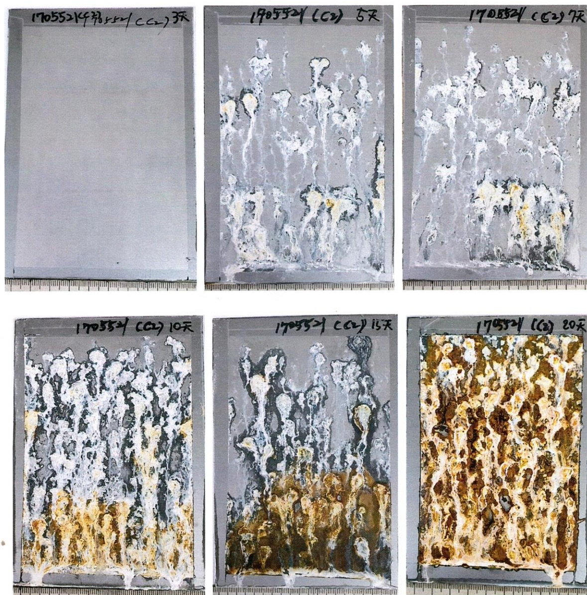
圖 1 1705521(C2 鉻酸處理)鹽霧試驗後外觀
