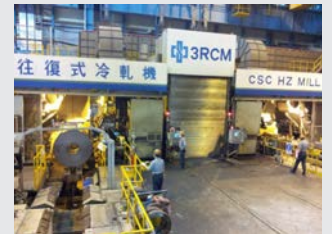
第 3 往復式冷軋機熱試車作業
