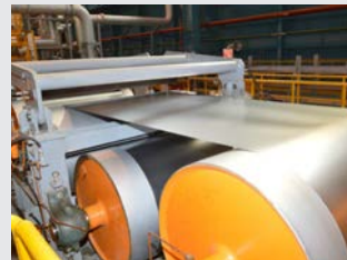
第 3 水平式退火塗覆線熱試車作業
