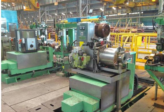
■ 精密檢驗產線適用於直徑 15~60mm 直棒鋼內部及表面的品質檢驗。
